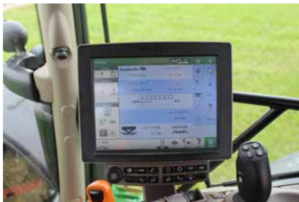
Nopeudenmittauksella varustetuissa levittimissä voimanoton kierroksia voi seurata suoraan näytöltä.
