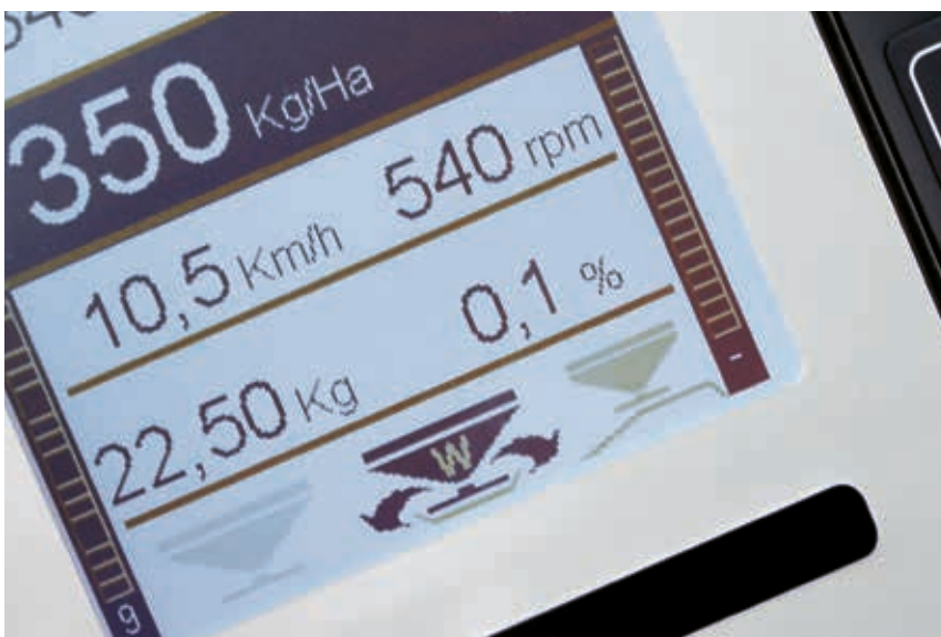
Vaakamallin levittimet kalibroidaan levityksen aikana automaattisesti, joten manuaaliseen kiertokokeen tekoon ei ole tarvetta.
