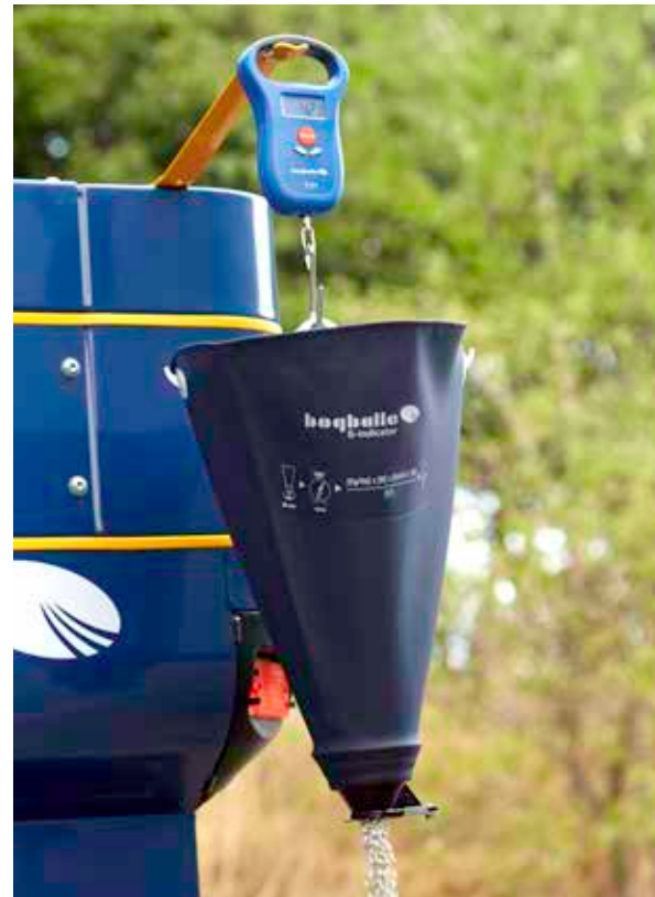
S-indikaattori on helppokäyttöinen ja kattava kiertokoe, jolla käytettävän lannoitteen testin voi tehdä muutamassa minuutissa.
