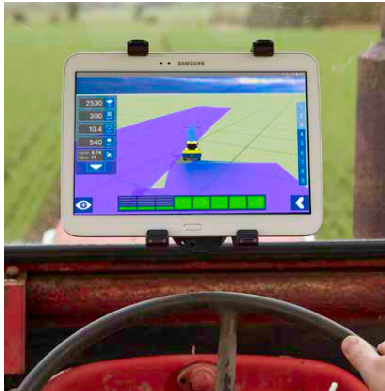
Käytä Android tablettia lohkoautomatiikan ja ajonopeuden mukaan säätävän levitysmäärän GPS: ohjaukseen. Tämä tarjoaa mahdollisuuden päivittää jopa tilan vanhin traktori uusimpaan GPS tekniikkaan.
