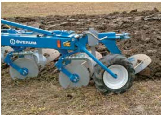
Traktorikuvioinen matalaprofiilirengas kantaa hyvin ja kulkee mukavasti.
