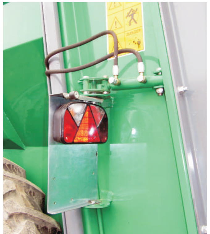
Hydraulisesti kääntyvät takavalot on kytketty yhteen peräportin hydrauliiikan kanssa.
