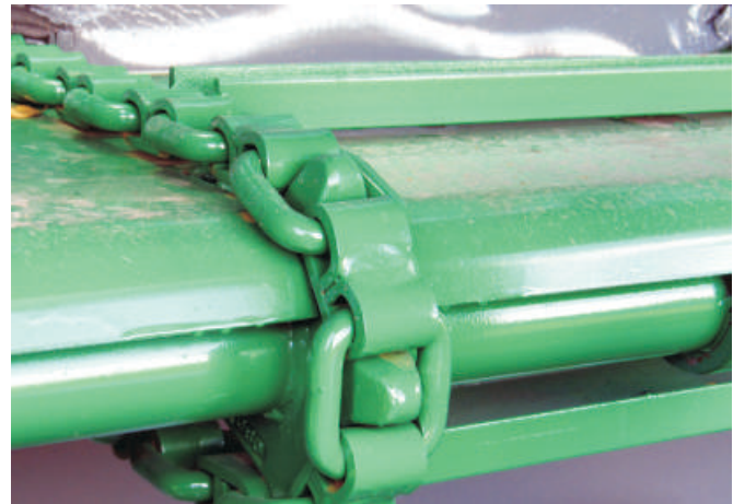
Ketjun lenkkien kosketuspinnat ovat laajat ja kuluminen sen vuoksi vähäistä.
