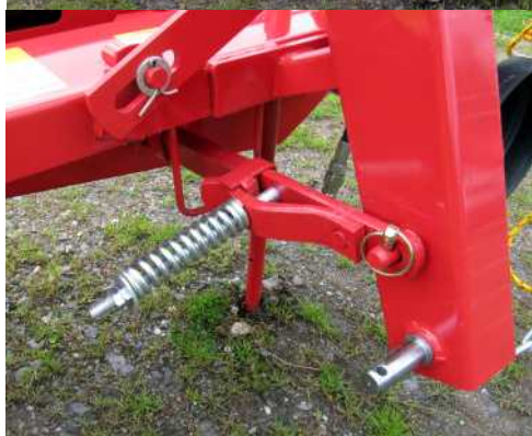
Agrow niittokoneissa on rungon laukaisulaite törmäyssuojana.
