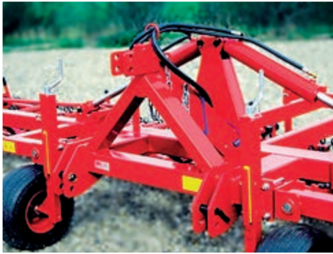
KytKentäjärjestelmä 12,00 ja 14,00 m malleissa kiinteä vahvistettu runko.
