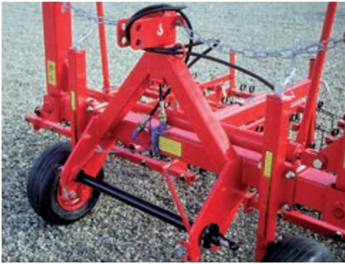
KytKentäjärjestelmä 6,00, 7,50 ja 9,00 m malleissa irroitettava palkki.
