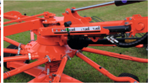
GA 7501 +, hydraulisella työleveyden säädöllä
