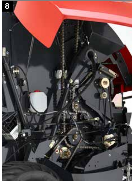
Korkealaatuisin IWIS-ketjuin varustettu tehokas voimansiirto + 1¼ tuuman ensisijainen 20BH-voimansiirto kromilla kovetetuin tapein
