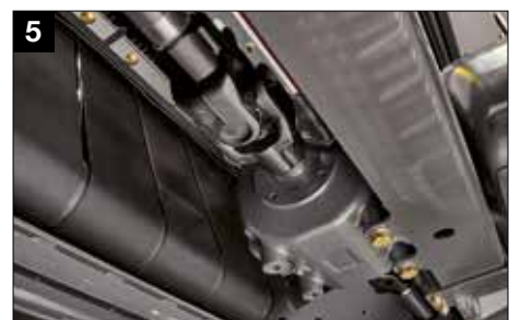
Raskaat ristiytkimet käyttöakseleissa
