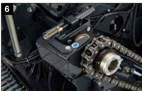
6 Vakiona hydraulinen roottorisullojan irtikytöntä
