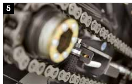
Vahvat ja leveät harjat varmistavat täydellisen ketjuvoitelun
