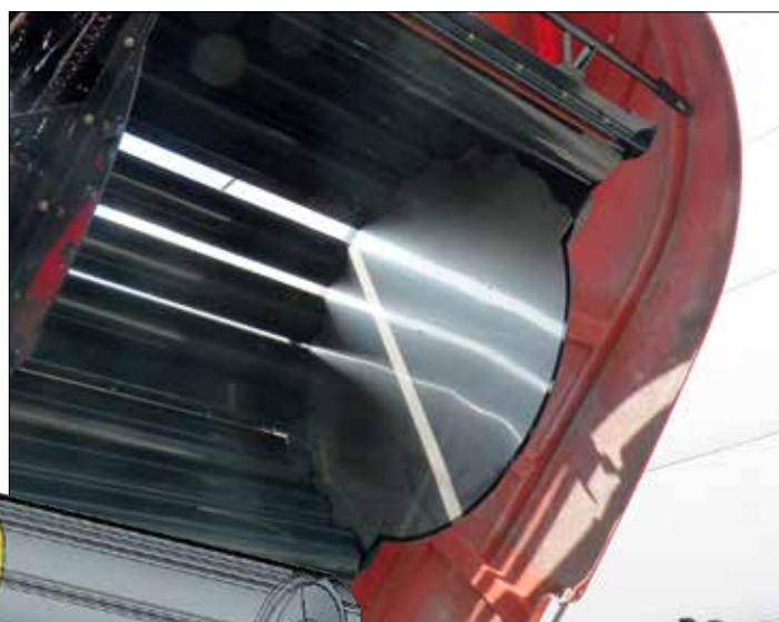
Ruostumattomasta teräksestä valmistetut vähäkitkaiset sivulevyt
