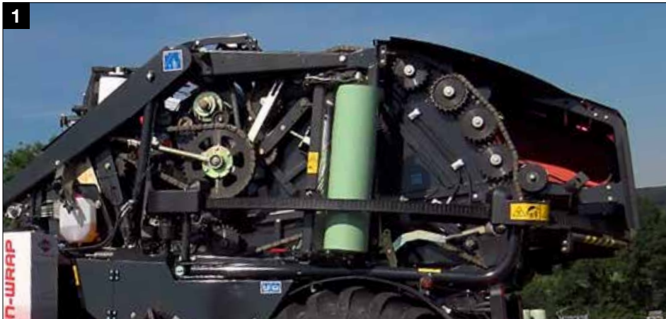
Vankkarakenteinen voimansiirto korkealuokkaisilla IWS ketjuilla
