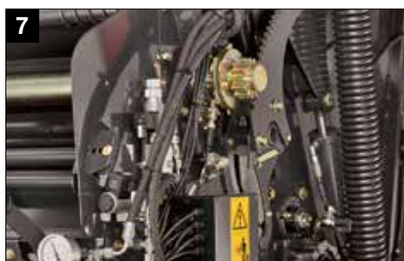
Ohjaamossa olevan tiiviyden säädön proportionaaliventtiili
