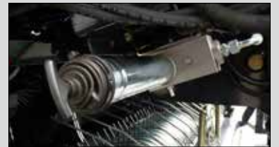
Beka Max automaattinen laakerien voitelujärjestelmä
