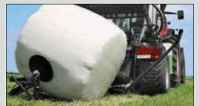
Paalin käännin, paali kääntyy kyljelleen
