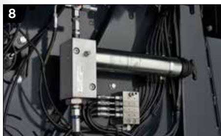
8 Vakiona telalaakerien automaattinen voitelujärjestelmä
