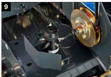
Beka Max jatkuvatoiminen ketjuvoitelujärjestelmä
