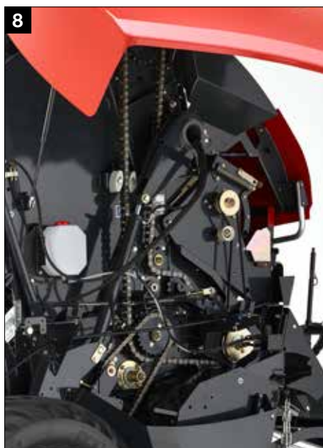
Vankkarakenteinen voimansiirto korkealuokkaisilla IWIS ketjuilla + 1¼" 20BH ensiövoimansiirtoketjut kromatuilla ja karkaistuilla ketjurullilla
