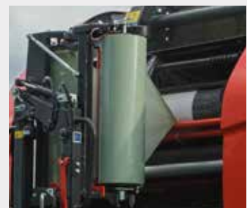
Kaksoisrullaa käyttävä TWIN-reel-kalvosidonta
