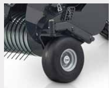
Kääntyvät osin ilmatäytteiset noukkimen tukipyörät
