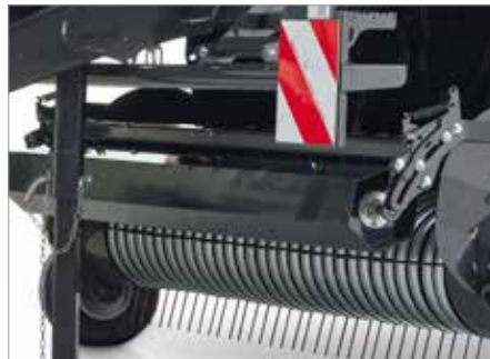
5. Jousipiikeillä ja isolla noukkimen paininrullalla (Ø 217 mm) parennetaan rehun virtaa
