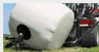
Paalin käännin, paali kääntyy kyljelleen
