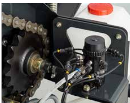
6. Beka-Max jatkuvatoiminen ketjuvoitelujärjestelmä
