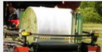
Kaksoisrullaa käyttävä TWIN-reel-kalvosidonta
