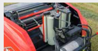
Kaksoisrullaa käyttävä TWIN-reel-kalvosidonta
