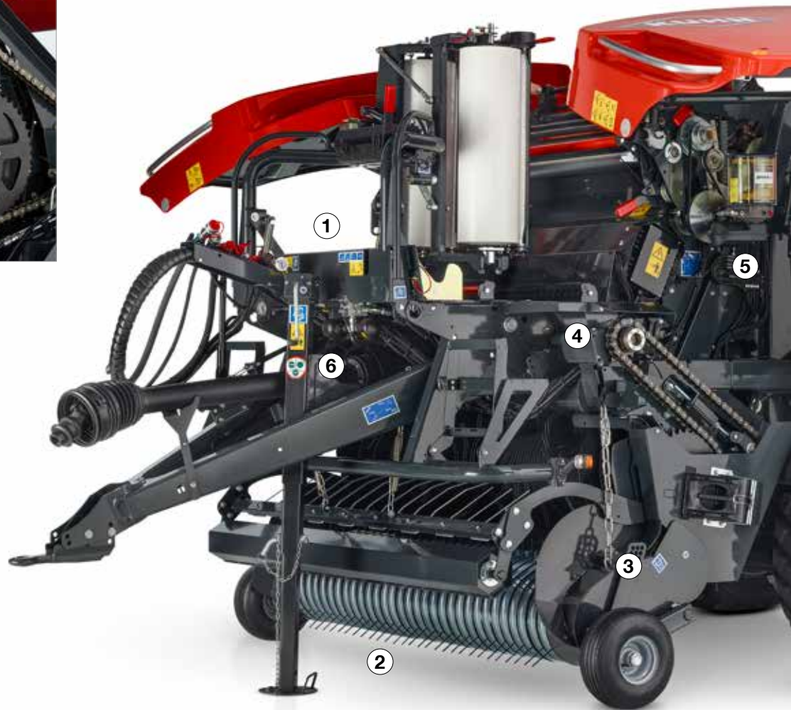
1. Vankkarakenteinen voimansiirto korkealuokkaisilla IVIS ketjuilla
