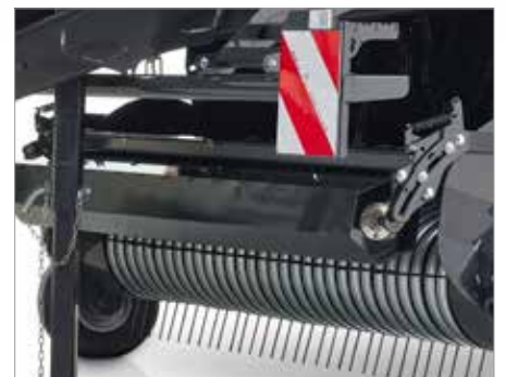
4. Jousipiikeillä ja isolla noukkimen paininrullalla (Ø 217 mm) parennetaan rehun virtaa
