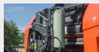
Kaksoisrullaa käyttävä TWIN-reel-kalvosidonta
