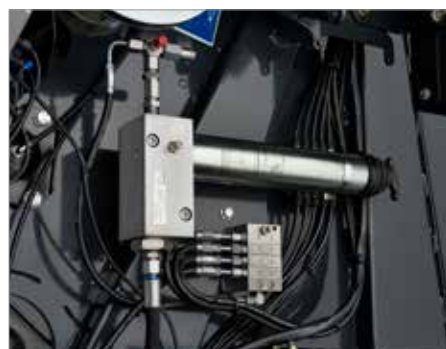
5. Vakiona telalaakerien automaattinen voitelujärjestelmä
