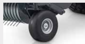
Kääntyvät osin ilmatäytteiset noukkimen tukipyörät
