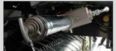
BEKA-MAX automaattinen laakerien voitelujärjestelmä
