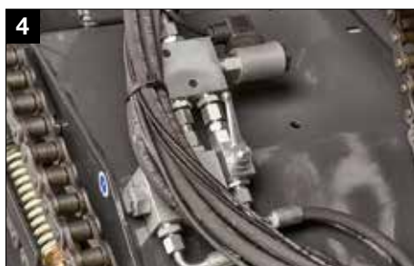
Erillinen terä / ALASLASKETTAVAA pohjaa hallitaan traktorin ohjaamosta
