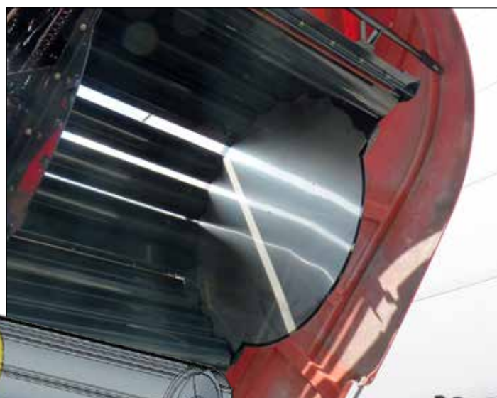
Ruostumattomasta teräksestä valmistetut vähäkitkaiset sivulevyt
