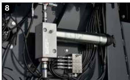
Vakiona telalaakerien automaattinen voitelujärjestelmä
