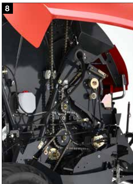
8 Vankkarakenteinen voimansiirto korkealuokkaisilla IWIS ketjuilla + 1 1/4" 20BH ensiövoimansiirtoketjut kromatuilla ja karkaistuilla ketjurullilla
