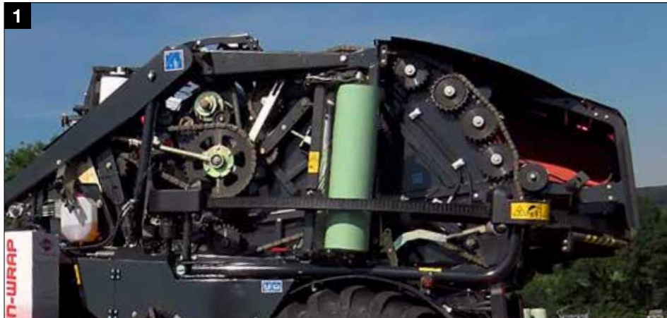
Vankkarakenteinen voimansiirto korkealuokkaisilla IWS ketjuilla
