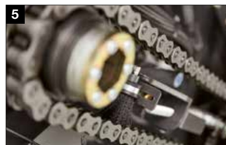
Vahvat ja leveät harjat varmistavat täydellisen ketjuvoitelun
