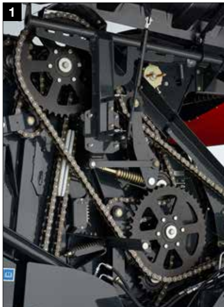
Vankkarakenteinen voimansiirto korkealuokkaisilla IWIS ketjuilla
