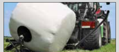
Paalin käännin, paali kääntyy kyljelleen
